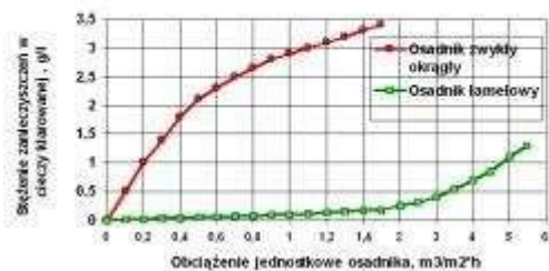
PORÓWNIANIE STĘŻENIA KOŃCOWEGO CIECZY SKLAROWANEJ W OSADNIKACH KLASYCZNYCH I LAMELOWYCH
